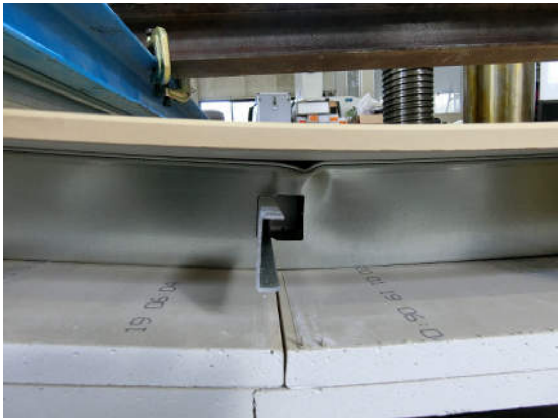
写真 5 試験体シリーズ No.4 (#07) 終局状況
