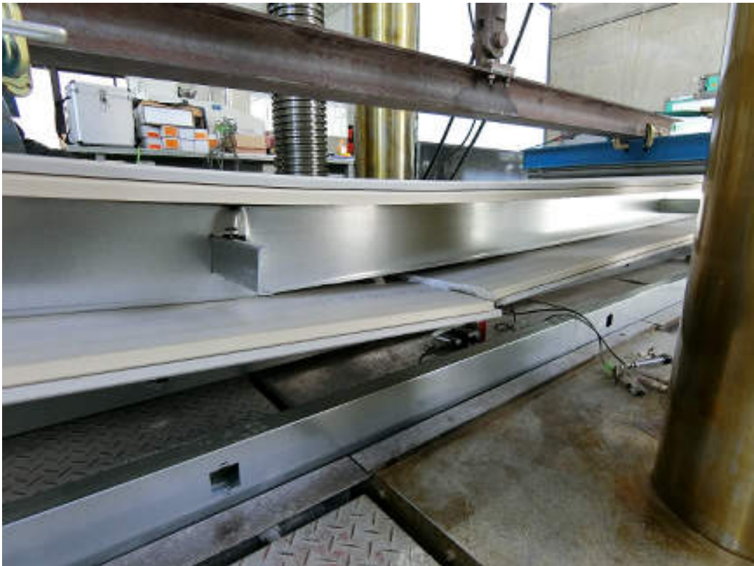
写真 9 試験体シリーズ No.8 (#04) 終局状況
