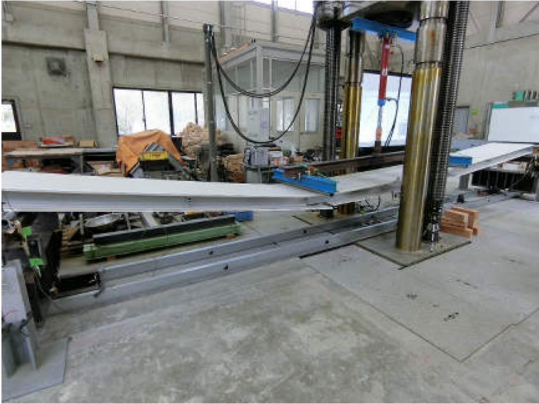
写真 8 試験体シリーズ No.7 (#19) 終局状況
