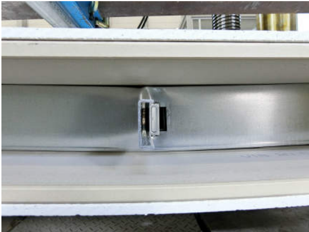
写真 7 試験体シリーズ No.6 (#01) 終局状況
