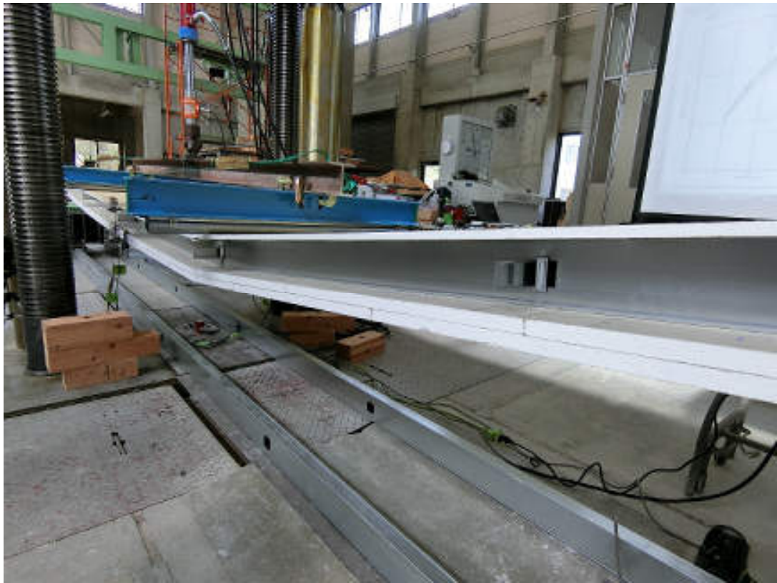
写真 4 試験体シリーズ No.3 (#16) 終局状況
